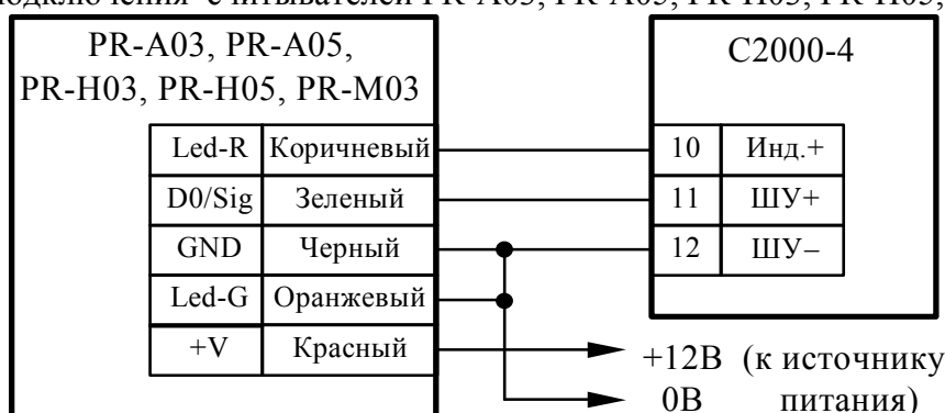
Схема подключения считывателей PR-A03, PR-A05, PR-H03, PR-H05, PR-M03
